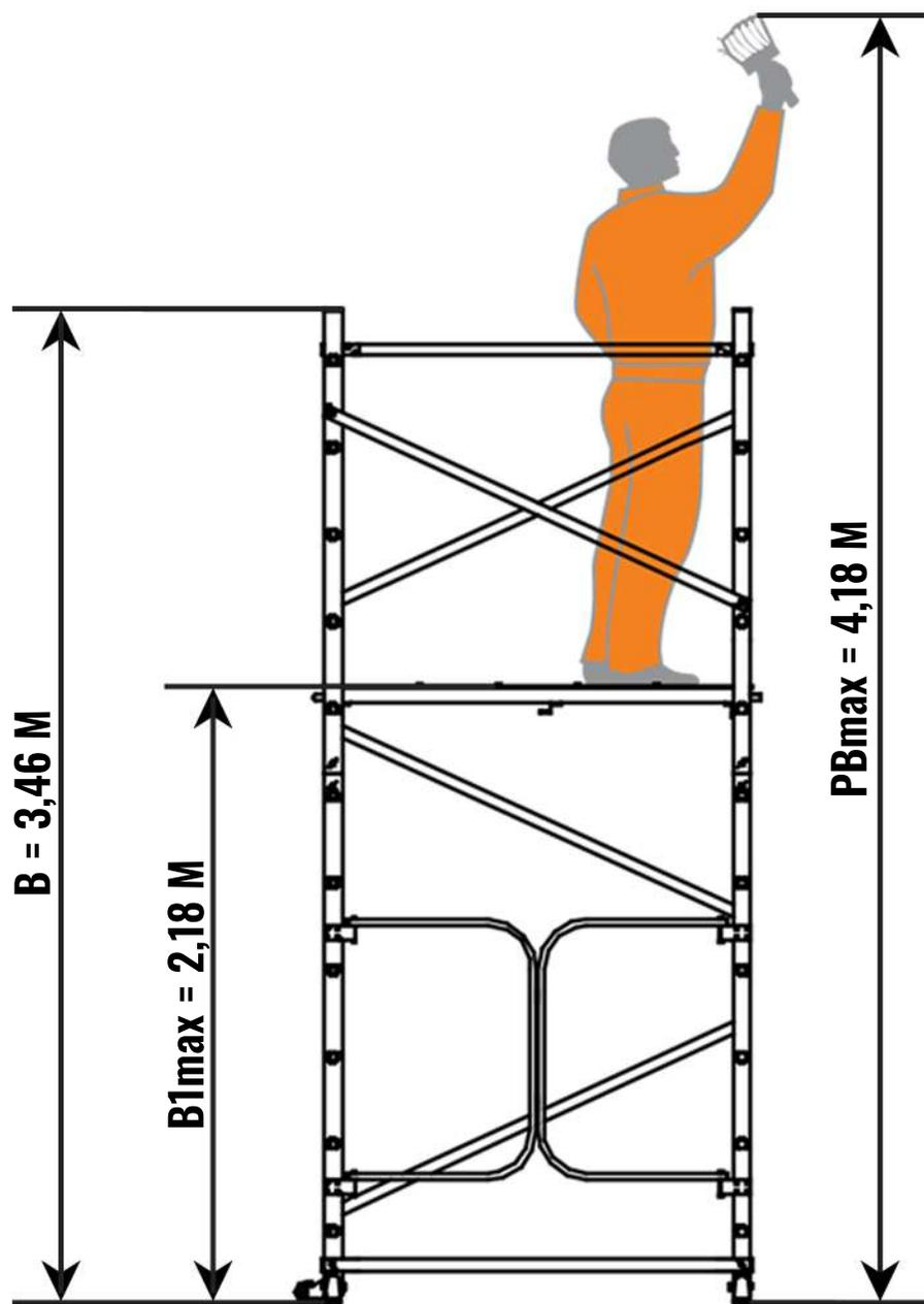
Подмости складные мобильные “Максимыч 1х6” с дополнительным ярусом
